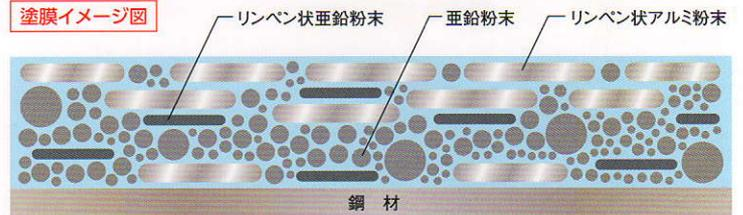
亜鉛粉末、リンベン状亜鉛粉末、更にはリンベン状アルミ粉末が、強固な層状塗膜を形成。防壁のような塗膜が、腐食の脅威から鋼材を防御します。
